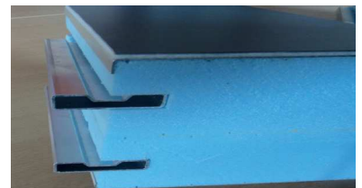
Gamme Auto-portant: épaisseurs 55, 85 et 168 mm Références: AX55S, X85SR16, X168SR16
