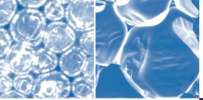
Un principe de stabilité issu de la nature: La structure nid d'abeilles du noyau KAPA® en mousse polyuréthane vue au microscope.
